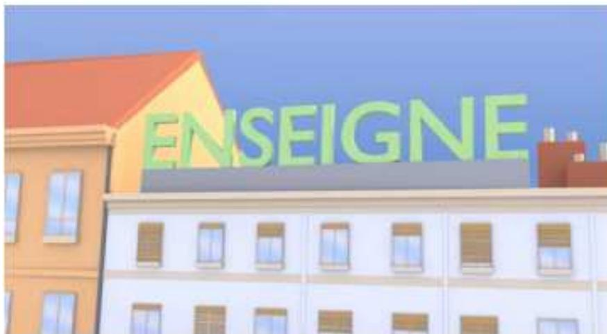
Une enseigne en toiture (comme une publicité) doit être composée de lettres découpées sans fixations visibles. Bandeau technique de 0,50 m maximum.
